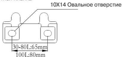
Вставьте пластиковые дюбели в отверстия. Далее с помощью винтов, вставленных в дюбели, закрепите ответные планки к стене.
